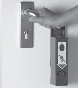
Beim Durchdrücken der Türklinke verschiebt sich der EH-Türwächter automatisch nach unten und ermöglicht mit nur einem Handgriff das Begehen der Notausgangstür. Dabei wird Daueralarm ausgelöst, der nur mit dem Geräteschlüssel gelöscht werden kann.
