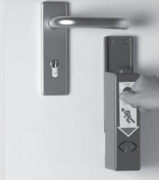
Mit dem Geräteschlüssel kann der Türwächter durch Verschieben nach unten alarmfrei in eine Dauerfreigabeposition gebracht werden. In dieser Position ist die Tür normal begehbar. Ein Daueroffenkontakt ist auf Wunsch möglich.
