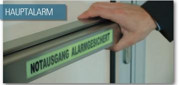
Bei komplettem Durchdrücken der GfS e-Bar<sup>®</sup> ist das Passieren des Notausgangs möglich. Hierbei wird der optische (blinkendes grünes Display) und der akustische Hauptalarm (95 dB/1 m) ausgelöst, der nur von einer autorisierten Person über den integrierten Schlüsselschalter quittiert werden kann. Eine automatische Alarmabschaltung nach 3 Minuten kann eingestellt werden.
