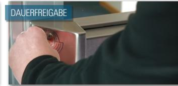
Berechtigte Personen begehen die Tür alarmfrei mittels Tastimpuls im integrierten Mittels integriertem Schlüsselschalter oder über einen Impulseingang kann die GfS e-Bar® in eine Dauerfreigabe-Position gestellt werden. Die Tür kann ohne Alarmauslösung begangen werden. Bei Netzspannung pulsiert das Display grün. Im Batteriemodus leuchten die LEDs alle 15 Sekunden kurz auf.
