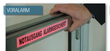
Bei leichtem Druck gegen die GfS e-Bar® wird ein optischer (Display pulsiert rot) und ein akustischer Voralarm (95 dB/1m) aktiviert, der wieder erlischt, sobald die GfS e-Bar® losgelassen wird. Die Tür bleibt geschlossen.
